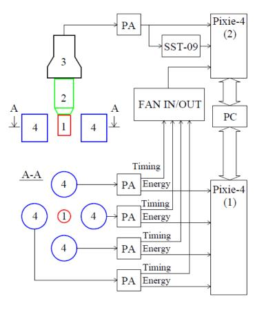
Calibration: <sup>22</sup>Na, <sup>60</sup>Co, <sup>137</sup>Cs, <sup>228</sup>Th <sup>106</sup>CdWO<sub>4</sub> – FWHM<sub> $\gamma$ </sub> = (21.7×E<sub> $\gamma$ </sub>)<sup>1/2</sup>
